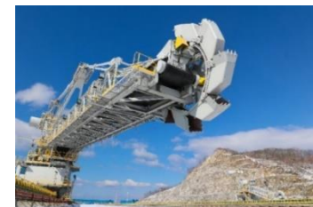
▲ Пример поставленного оборудования (реклемер)
