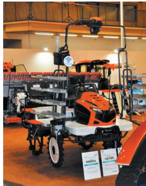
Машина, высаживающая саженцы риса, с автономным режимом работы
