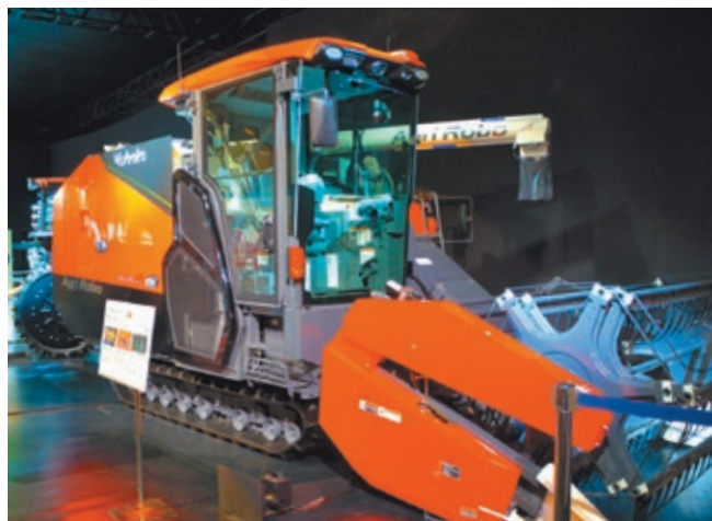
Комбайн с функцией вспомогательного автономного режима работы
